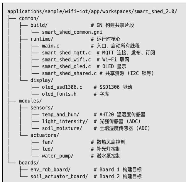
图 4 嵌入式端软件模块结构图
